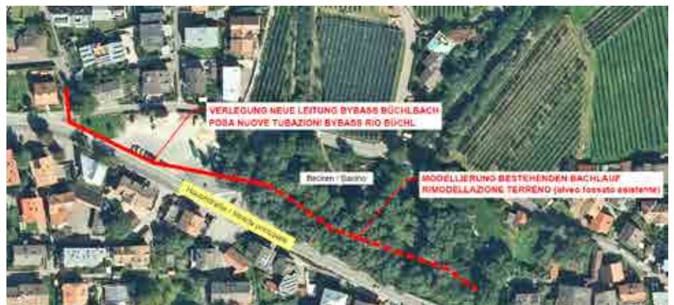
Durch die Verlängerung des Bypasses beim Büchlbach wird das 2. Baulos zur Sicherung der Zone Kompatsch umgesetzt, das Amt für Wildbachverbauung ist bereits dabei, das letzte Teilstück zu planen.
